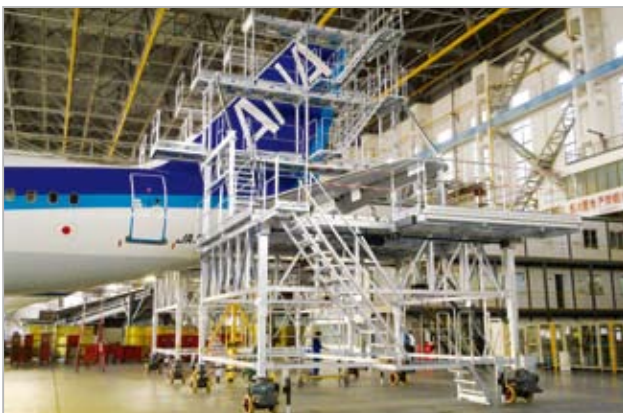
康得通用公司设计制造的上海STARCO钢制尾坞检修平台
