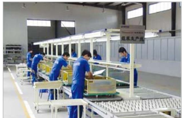
康得新能源公司高压变频组装生产线
